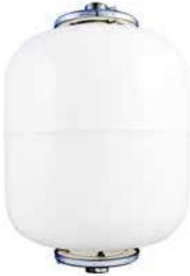
Il vaso solare dissipatore o di raffreddamento ha la funzione di proteggere la membrana del vaso d'espansione solare ESOL nel caso di surriscaldamenti eccessivi dovuti a impianti solari sovradimensionati o dotati di stazione solare installata in prossimità del campo solare e quindi sollecitati maggiormente alle elevate temperature.
