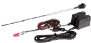
Anodo elettrico con attacco ½" (sostituisce l'anodo sacrificale in magnesio) per bollitori con capacità fino a 2.000 litri.
