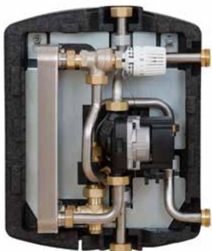
Modulo di produzione istantanea di acqua calda sanitaria controllato grazie all'integrazione di una valvola termostatica che gestisce la pompa di circolazione per determinare l'impostazione della temperatura di acqua calda sanitaria.
