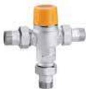
Miscelatore termostatico per impianti sanitari regolabile ad elevate prestazioni, adatto per impianti solari con sicurezza antiscottatura. Completa di attacchi filettati corpo valvola da 1" M con attacchi 1" F x 3/4" M. Pressione/temperatura massima d'esercizio 10 bar/100°C.
