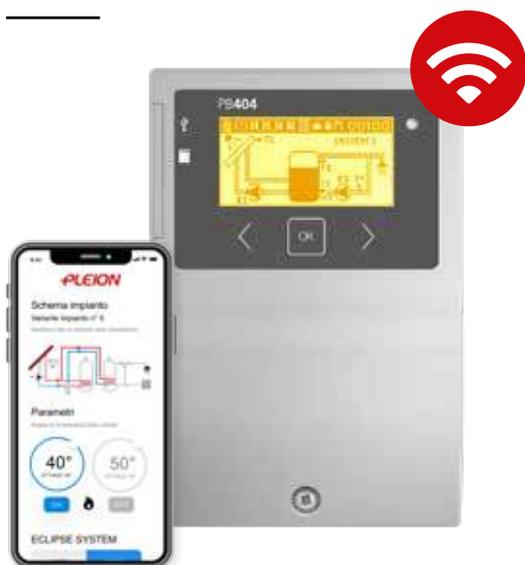
**LE CENTRALINE SOLARI PB404 E PB404 WI-FI** sono i regolatori elettronici efficienti, universali e economici per la gestione di impianti solari e di riscaldamento dotati di pompe ad alta efficienza che necessitano di un controllo sicuro, durevole e corretto nel tempo. Le centraline sono caratterizzate da 4 ingressi e 4 uscite, con 14 sistemi di gestione preconfigurati secondo necessità.
