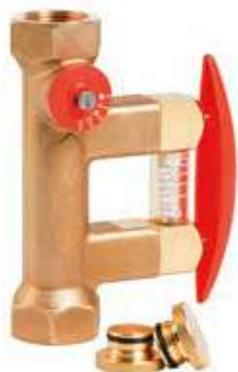
Le valvole di bilanciamento consentono la comoda e precisa regolazione dei flussi volumetrici nelle diverse ramificazioni di un impianto solare centralizzato ottimizzando così l'energia catturata da ciascun sottocampo solare, visualizzando anche la portata in ogni istante "il riferimento di lettura è lo spigolo inferiore del corpo del galleggiante".
