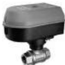
Valvola deviatrice con servomotore 230Vac/50-60Hz per la gestione del ritorno all'accumulo Puffer, potendo stratificare in funzione della temperatura in uscita dal modulo sanitario. Da utilizzare anche nel caso di carichi di accumuli solari. Azionabile manualmente in assenza di tensione e dotata di 4 cavi di collegamento da 0,5mm<sup>2</sup>. Durata e angolo di rotazione di 30s/90°.
