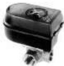
Valvola deviatrice a tre vie completamente in ottone speciale e completa di servomotore con controllo a 3 punti. Da utilizzare anche nel caso di carichi di accumuli solari. Azionabile manualmente in assenza di tensione e dotata di 4 cavi di collegamento da 0,5mm<sup>2</sup>. Durata e angolo di rotazione di 18s/90°.
