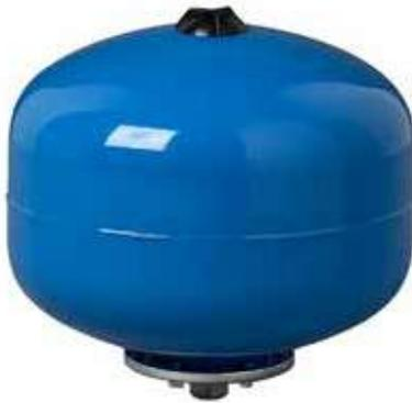
Il vaso d'espansione per impianti sanitari con **membrana intercambiabile** in EPDM, per temperature da -10÷100°C e pressioni di 10 bar, colore della verniciatura esterna RAL 5015.
