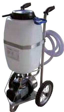
Stazione per il caricamento degli impianti solari in grado di assicurare il corretto riempimento ed eliminazione dell'aria presente nelle tubazioni in maniera semplice, veloce e pulita. Dotata di filtro sul lato di aspirazione, indicatore di livello, interruttore ON/OFF e tubo per caricamento impianto trasparente per il controllo visivo durante l'utilizzo.
