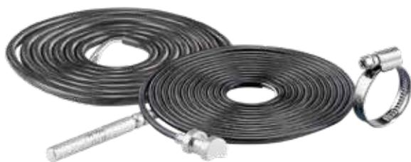
Sensore di temperatura ad immersione o a contatto in base all'applicazione, installabile all'interno di pozzetto portasonda o a contatto di condutture per mezzo di fascetta metallica.
