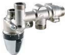
Valvola composta in un unico corpo in lega di ottone e selettore in materiale plastico, da una parte deviatrice termostatica a punto fisso non regolabile a 48°C (+/-1°C) e da una seconda parte miscelatrice termostatica regolabile 30-56°C (±1°C) con sicurezza antiscottatura.
