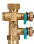
In un unico corpo la possibilità di effettuare il caricamento del circuito solare grazie alla valvola di intercettazione presente al centro del corpo valvola. Completa nel tratto di carico-scarico di rubinetti con tappo di chiusura. Temperatura massima 120°C, pressione massima 6 bar. Attacchi: DN20, G1 AG - G1
