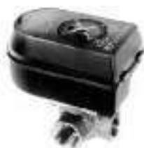
Vanne déviatrice à trois voies totalement en laiton spécial et munie de servomoteur avec contrôle à 3 points. À utiliser en cas de remplissages de ballons solaires. S'enclenche manuellement à l'absence de tension et munie de 4 câbles de connexion de 0,5mm<sup>2</sup>. Durée et angle de rotation de 18s/90°.
