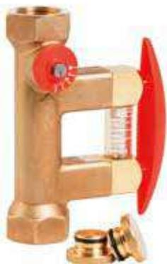
Les vannes d'équilibrage permettent une régulation commode et précise des débits volumétriques dans les différentes ramifications d'une installation solaire centralisée. Elles optimisent de ce fait l'énergie capturée par chaque sous-groupe de champ solaire, en affichant également le débit à chaque instant « la référence de lecture est l'angle inférieur du corps du flotteur ».
