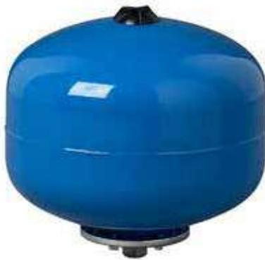
Le vase d'expansion pour installations sanitaires avec **membrane interchangeable** en EPDM, pour des températures de -10 à 100°C et des pressions de 10 bars, couleur de la peinture extérieure RAL 5015.
