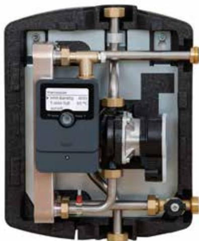
Module de production instantanée d'eau chaude sanitaire électronique qui permet différentes options, programmes pour le circulateur, fonctions pour l'installation en cascade pour un maximum de 4 modules. **Le contrôle électronique garantit toujours la température minimale de retour vers le ballon en gage d'une exploitation optimale de l'énergie renouvelable fournie par le soleil et par une pompe de chaleur.**
