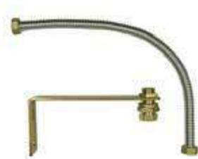
Kit prévu pour le raccordement rapide et efficace du vase d'expansion solaire ESOL (jusqu'à la taille de 50l). Le kit comprend un tuyau flexible en acier de 1 m de  $\frac{3}{4}$ " avec écrous libres à joints à butée plate des deux côtés, raccord d'arrêt manuel de  $\frac{3}{4}$ " pour le raccordement au vase d'expansion afin de permettre son détachement de l'installation au cas où des opérations d'entretien ou autre seraient nécessaires, étrier de support de vase avec fixation murale.
