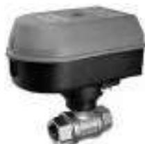
Vanne déviatrice à servomoteur 230Vac/50-60Hz pour la gestion du retour du ballon de stockage Puffer, capable de stratifier en fonction de la température à la sortie du module sanitaire. À utiliser en cas de remplissages de ballons solaires. S'enclenche manuellement à l'absence de tension et munie de 4 câbles de connexion de 0,5mm<sup>2</sup>. Durée et angle de rotation de 30s/90°.
