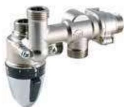
Vanne composée d'un seul corps en alliage de laiton et sélecteur en matière plastique, d'une partie déviatrice thermostatique à point fixe non réglable à 48°C (+/-1°C) et d'une seconde partie mélangeuse thermostatique réglable 30-56°C (±1°C) avec sécurité contre les brûlures.
