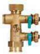
Il permet, dans un seul corps, de remplir la boucle solaire grâce à la vanne d'arrêt se trouvant au centre du corps de la vanne. Avec robinets à bouchon pour la fermeture du tronçon de remplissage-vidange. Température maximale 120°C, pression maximale 6 bars. Raccords: DN20, G1 AG - G1
