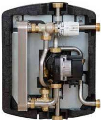
Module de production instantanée d'eau chaude sanitaire contrôlée grâce à l'incorporation d'une vanne thermostatique qui gère la pompe de circulation pour déterminer le réglage de la température de l'eau chaude sanitaire.
