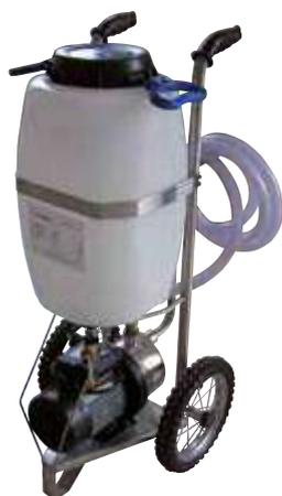
Station de chargement des installations solaires qui assure le bon chargement et l'élimination de l'air se trouvant dans les tubes de façon simple, rapide et propre. Munie de filtre du côté de l'aspiration, d'un indicateur de niveau, d'un interrupteur ON/OFF et d'un tube de chargement transparent de l'installation pour son contrôle visuel pendant l'utilisation.
