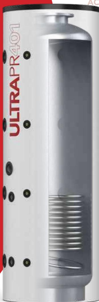
**MODULO ACS Istantanea ULTRAFRESH 401** (a piastre) per la produzione di acqua calda sanitaria con ampia superficie di scambio, completo di tutti i componenti necessari per il corretto funzionamento e gestione del sistema, quali circolatore primario, flussostato e valvola termostatica di regolazione.
