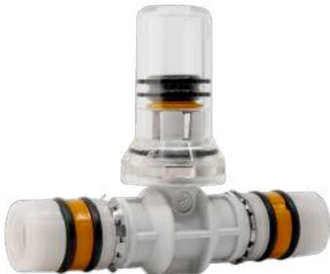
Gamma completa di raccordi ed adattatori ad innesto rapido, per la realizzazione di sistemi radianti a parete e soffitto. Tenuta idraulica con doppio O-ring. I raccordi sono compatibili con tubazioni  $\varnothing$  20x2 mm e  $\varnothing$  8 x 1 mm, sia PE-X che multistrato.
